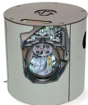
Para su funcionamiento, requiere de una fuente de poder estable y constante; por esta razón, se encuentra instalado únicamente en buques o embarcaciones de dimensiones adecuadas que permitan la capacidad de instalar una serie de circuitos eléctricos y electrónicos para su funcionamiento. Parte de la alimentación debe llegar al rotor del giróscopo, el cual gira a una velocidad entre 10 000 y 20 000 revoluciones por minuto.
