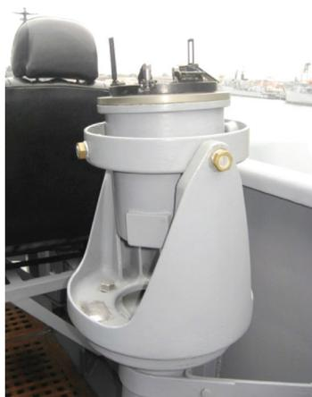
Un repetidor de girocompás está conformado por una rosa de compás, la cual se encuentra unida a un rotor cuyo motor sincrónico recibe las indicaciones de las señales eléctricas transmitidas por el girocompás maestro. Cuenta con una luz variable interior para su uso durante las noches.
