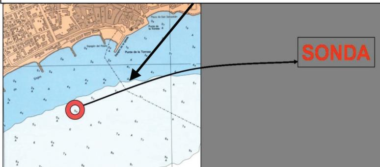
Si bien es cierto que, como ya se mencionó, su uso no es muy común para determinar la posición, es imprescindible mantener el conocimiento de la profundidad cuando nos encontremos navegando en aguas restringidas para mantener la seguridad de la embarcación.
