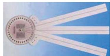
mediante la alidada o el sextante. Este instrumento, de latón o plástico, se compone de una escala circular que se puede leer en fracciones de un grado o minutos y que tiene los tres brazos adjuntos. La escala circular así como los tres brazos son móviles, de manera que facilitan su uso para ajustar las aberturas a los ángulos medidos.
