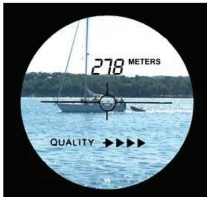
El Telémetro óptico es un equipo que tiene dos objetivos separados por una distancia fija conocida, y con ellos se dirige al objeto hasta que la imagen que recibimos de los objetivos se junta en una sola imagen; entonces es cuando el telémetro calcula la distancia al objeto a partir de la distancia fija conocida y de los ángulos subtendidos entre el eje de los objetivos y la línea de la distancia fija conocida, y, cuanto mayor sea esta, más preciso es el telémetro.
