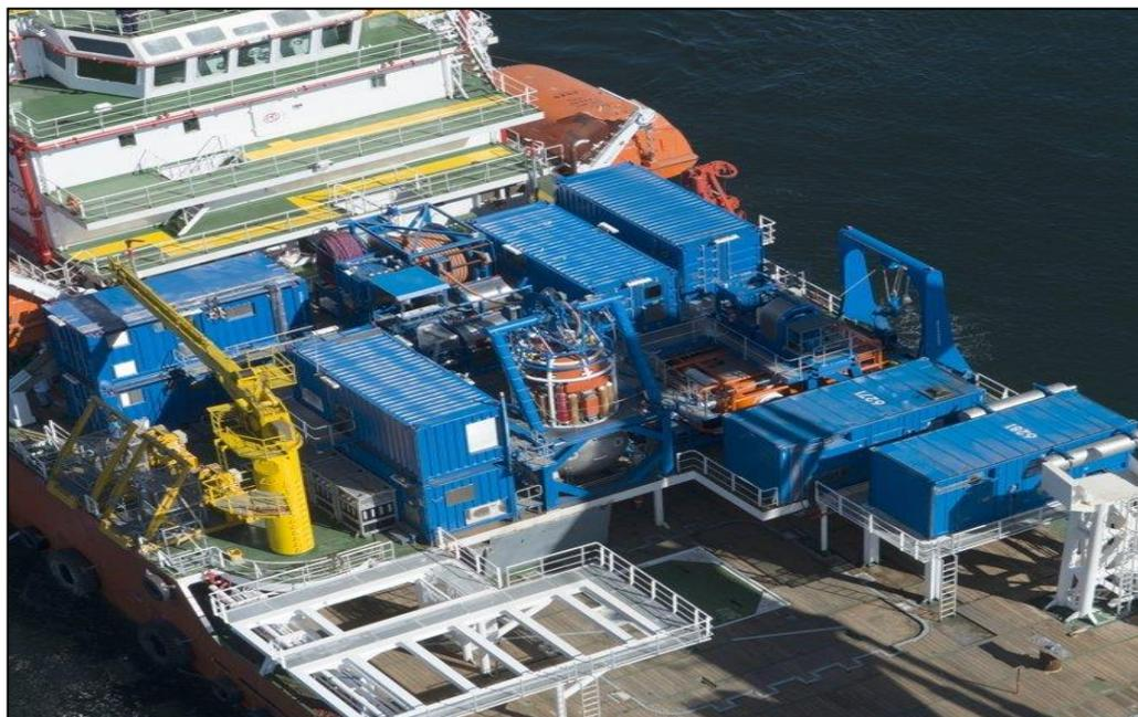
**Figura 6. Sistema de Saturación Móvil, Unique Group.**
