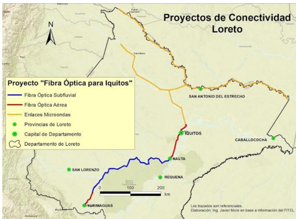
Figura 14. Proyecto de Conectividad Vía Internet para la Región Amazónica, recuperado de: http://telecomunicaciones-peru.blogspot.com/2020/06/fibra-optica-subfluvial-yurimaguas.html
