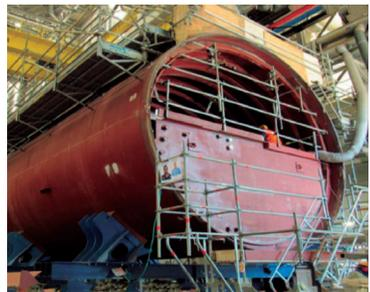
Imagen 10 y 11 : talleres de montaje de las secciones y de pre-equipamiento. Instalación de tanques internos.
