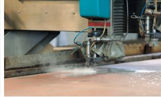
Imagen 8 : máquina de corte por hidrojet.
