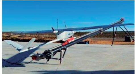
Figura 3: sistema UAV de ala fija TUCÁN.
