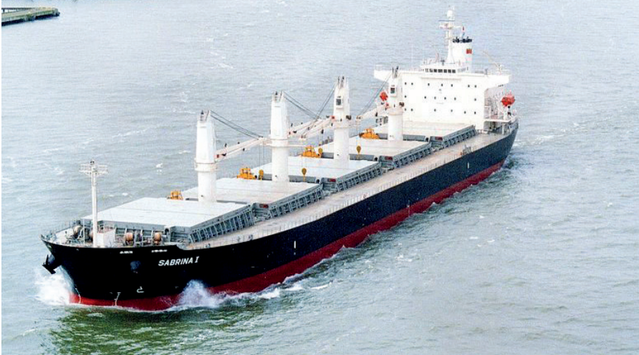
Imagen: El Sabrina I fotografiado desde lo alto del puente Astoria-Megler. El Sabrina I, un típico granelero handymax moderno con 5 bodegas, 5 escotillas y 4 grúas, es propiedad de Portline de Portugal y fue construido en el astillero de Balamban (Cebú), Filipinas, del constructor naval japonés Tsuneishi Heavy Industries. El buque fue entregado en enero de 2005. Autor: Nsandel en Wikipedia en inglés.
