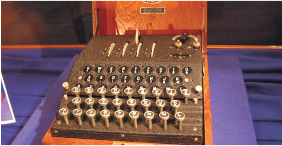
La máquina Enigma que disponía de un mecanismo de cifrado rotatorio, que permitía usarla tanto para cifrar como para descifrar mensajes. Foto: Steve Montana Photography.
